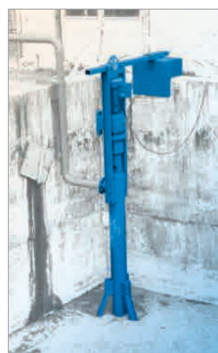
KL-T in Betrieb mit Hängebügel und Dreipunktaufstellung
