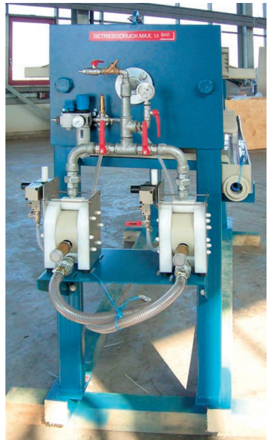
TF 50 in Tandemanordnung für maximale Betriebssicherheit.
