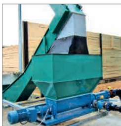
Beschickung der Pumpe über einen Übergabetrichter
