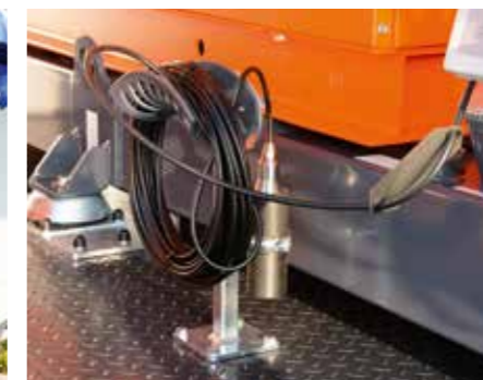
Automatikbetrieb über Höhenstandsonde
