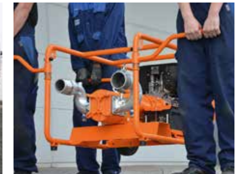
mit Verbrennungsmotor von vier Personen tragbar
