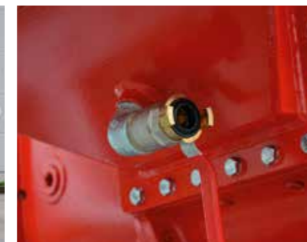
Ablass zur Restentleerung
