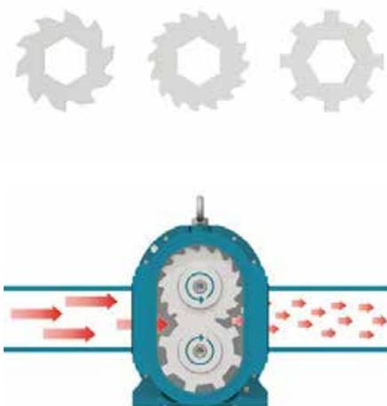
*Le Unihacker est un broyeur à double arbre parallèles et à couteaux multiples. Il peut être installé à l'aspiration de pompes ou encore en protection de centrifugeuses par exemple.*
