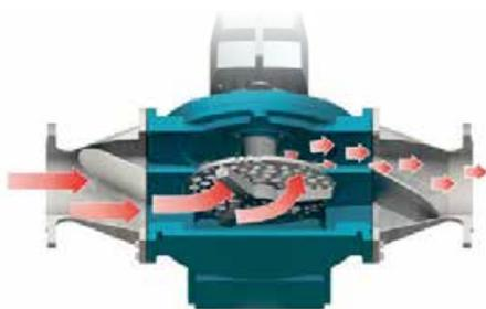
Le multichopper Börger est un robuste dilacérateur en ligne. Le réglage automatique des couteaux vous assure un effet de coupe optimal en toutes circonstances. Le multichopper est disponible en trois tailles pour des débits maximum de 400 m<sup>3</sup>/h.
