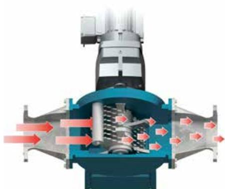
Le rotocruasher est un robuste dilacérateur s'intégrant en ligne sur la tuyauterie. Les couteaux rotatifs et les contre-couteaux sont disposés en alternance et séparés par des entretoises. Le rotocruasher intègre également un piège à cailloux intégré afin de séparer les indésirables.
