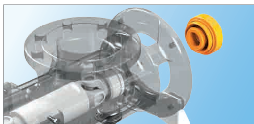
Démonter l'ancien ensemble d'étanchéité
