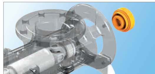
Alte Dichteinheit ausbauen
