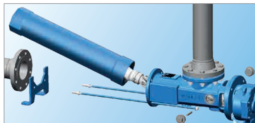
Schritt 3: Stator und Rotor inklusive Kardanwelle nach vorne bewegen, nach oben kippen und aus dem Pumpgehäuse herausziehen.
