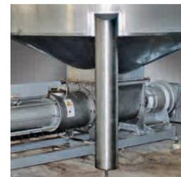
Alimentation dans une pompe à vis excentrique KL100RL120-8 V4A
