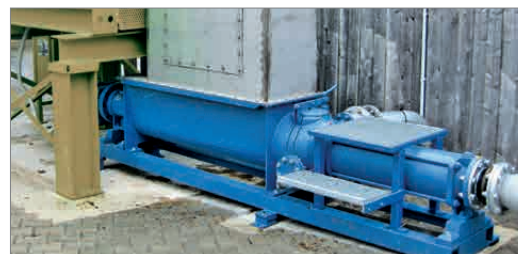
Dépôt de produits solides à destination du broyeur
