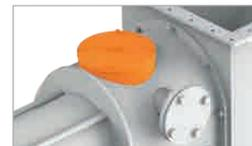
manchons à droite et à gauche pour la connexion variable de l'alimentation en liquide pour le mouillage
