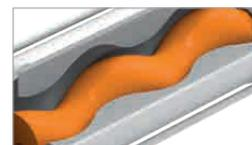
Entrée conique du stator pour un remplissage optimal Stators dans différentes géométries, de fabrication propre
